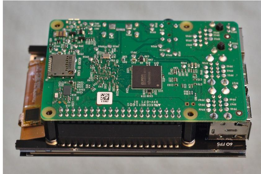
Montieren Sie den Raspberry PI 3B auf das HyperPixel 4 Display.
