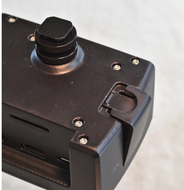
Die Firmware Klappe einsetzen, den Schnapper an der Mulde leicht herunterdrücken und dann die Klappe in das Gehäuse einrasten.
