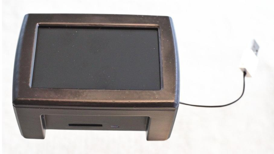
Setzen Sie den Displayrahmen in das Gerät ein. Achten Sie dabei auf die richtige Ausrichtung vom Display und dem Rahmen. Der Displayrahmen kann nur in einer Ausrichtung montiert werden!
