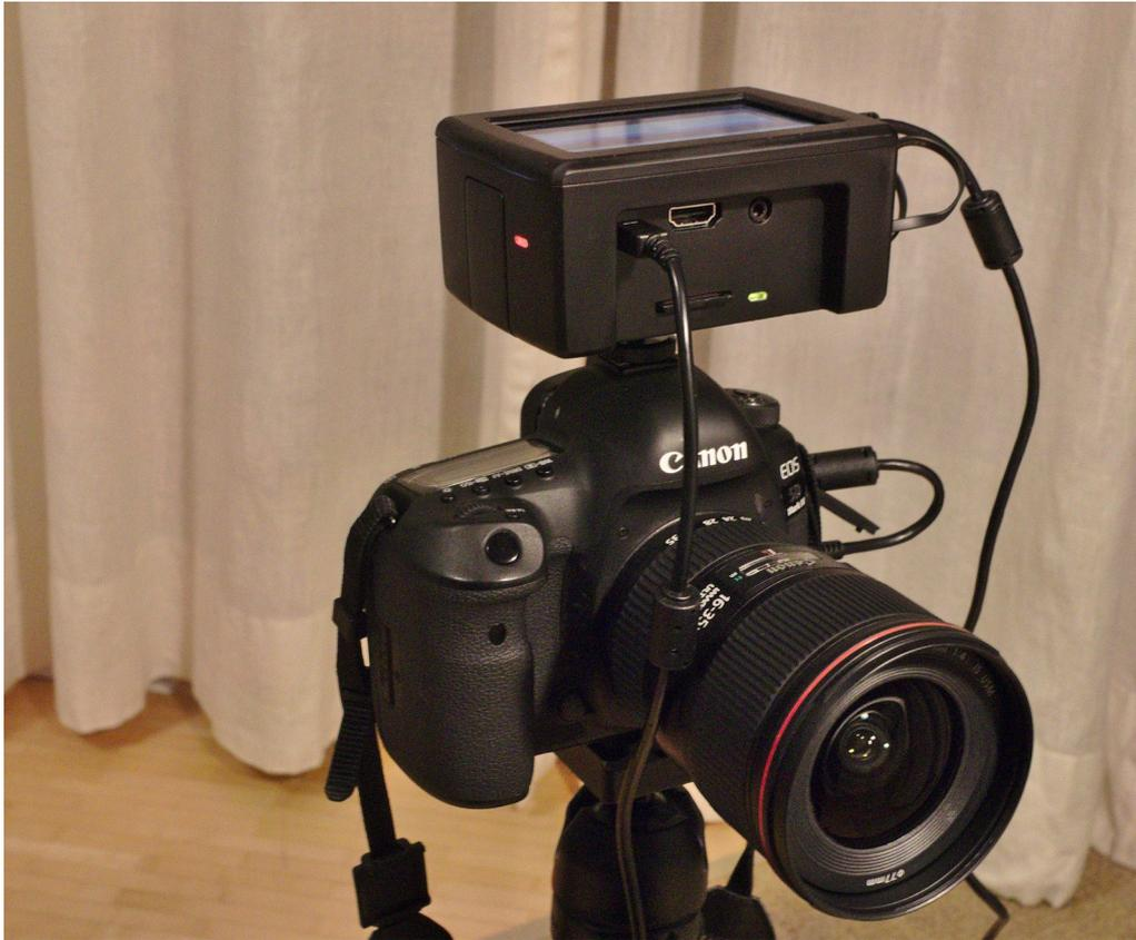
Das brand neue Advanced Camera Device ist eine Kamerasteuerung und ein mobiler Datenspeicher als Backup-System für zuhause und unterwegs. Das Advanced Camera Device, kurz ACD-1 genannt ist ein smartes Gerät, dass Ihr einfach per USB oder WLAN mit eurer Kamera verbindet. Die Stromzufuhr erfolgt über eine Powerbank eurer Wahl.
