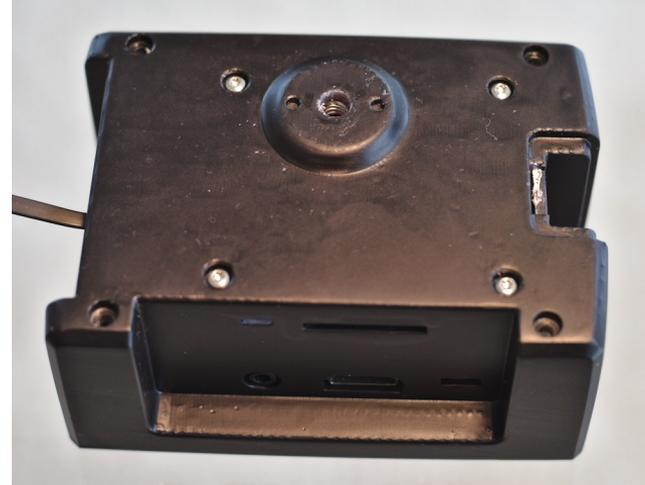
Verwenden Sie z.B. einen Nagel um die Bohrungen von Gehäuse, dem Kartenleser und den Bolzen vom Rechner in Flucht zu bringen. Befestigen Sie den Rechner am Gehäuse mit den vier M2,5x7 Schrauben
